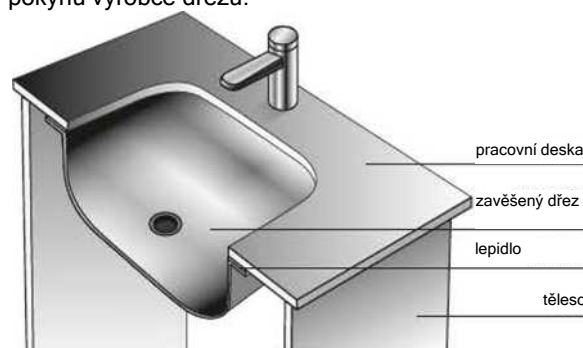
Obr. Upevnění zavěšeného dřezu - řez.
